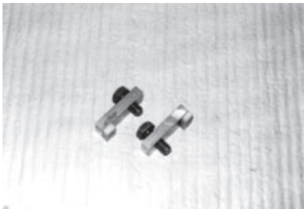
Bild 146: Druckstücke zum Andrücken des Zylinderblocks 5870 650 001
