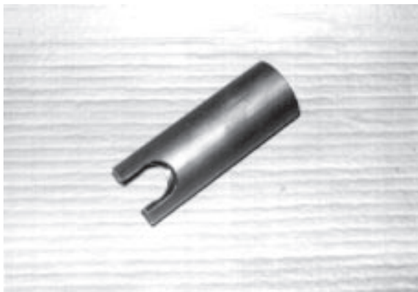
Bild 152: Druckhülse zum Zusammenpressen der Feder auf der Antriebswelle 5870 650 001
