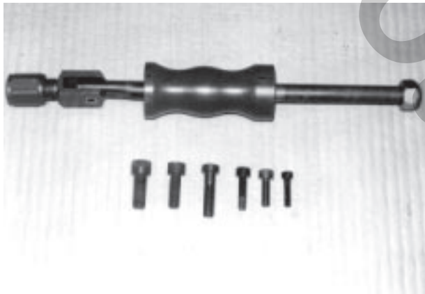
Bild 126: Schlagauszieher mit Einsätzen 5870 650 001
