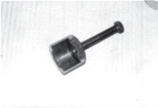
Bild 132: Abzieher für Planetenräder 5870 080 017
