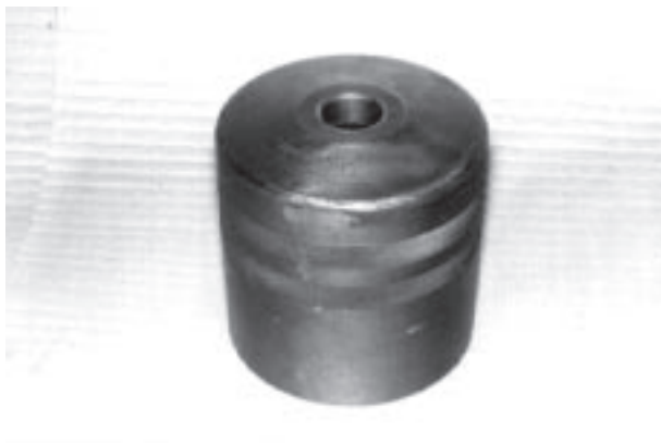
Bild 134: Hülse zum Auspressen der Lagerung und Aufdrücken des Hohlrades 5870 506 062
