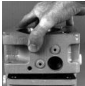
Fig. 61-3 - Remove End Cap
