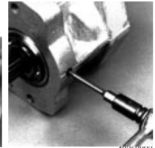
Fig. 65-9 - Remove Pipe Plug
